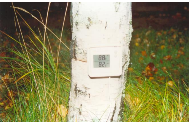
Maaperän mittauksen lämpömittari
